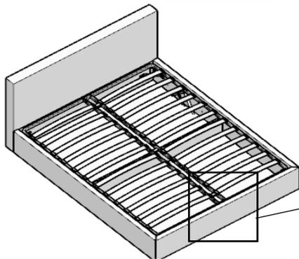
Зазор между царгой и рамой 7 мм ( $\pm 2$  мм)
