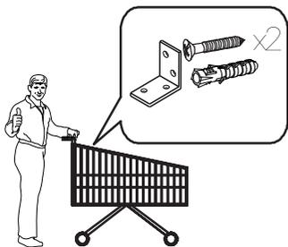
Для надежной устойчивости нужно зафиксировать шкаф к стене с помощью уголка. (Крепеж в комплект фурнитуры не входит)
