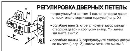
РЕГУЛИРОВКА ДВЕРНЫХ ПЕТЕЛЬ:
