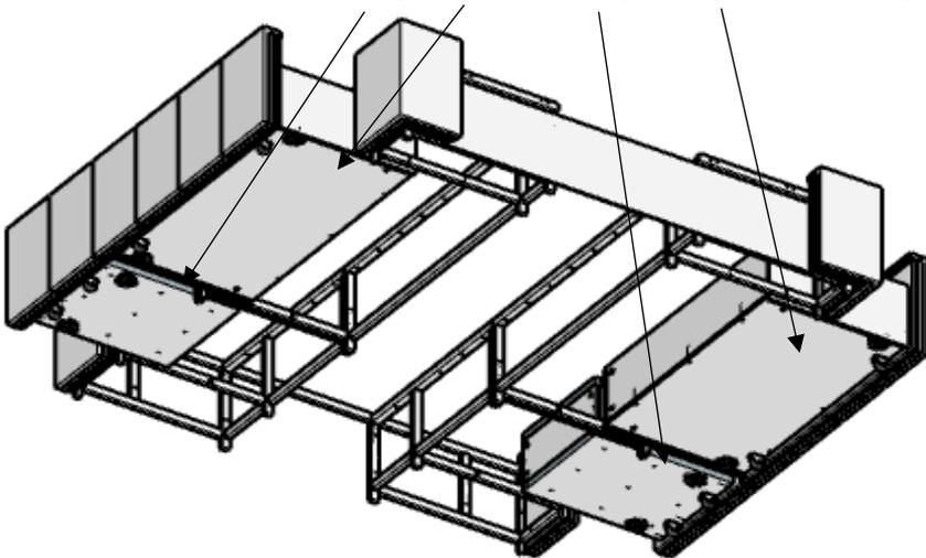
Задвинуть направляющую в фиксатор до щелчка.
