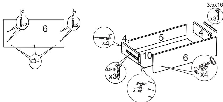
**Порядок монтажа шариковых направляющих полного выдвижения**
