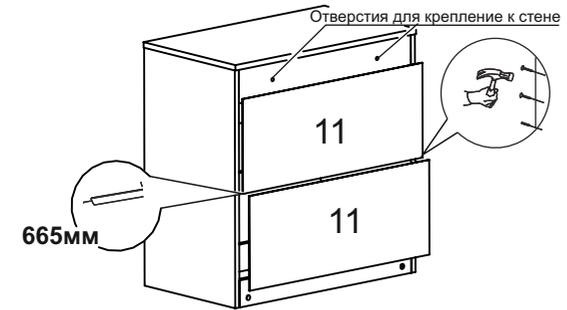
**Порядок монтажа шариковых направляющих полного выдвижения**
