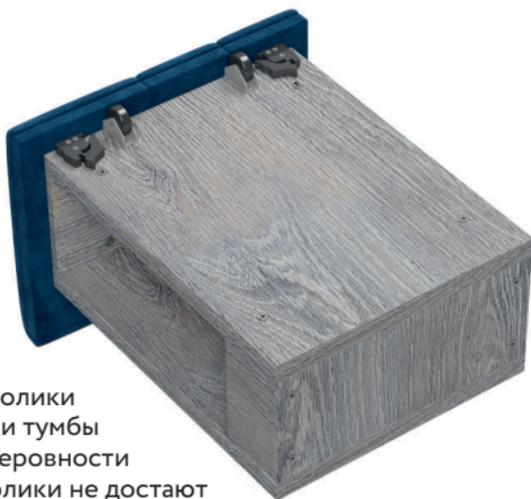
Проверить касаются ли ролики установленные на ящики и тумбы поверхности пола. При неровности пола, в следствии чего ролики не достают до пола, необходимо снять ящики и тумбы, открутить саморезы A1 и подложить необходимое число проставок G2 под ролики как показано на рисунке и заменить саморезы на A2.
