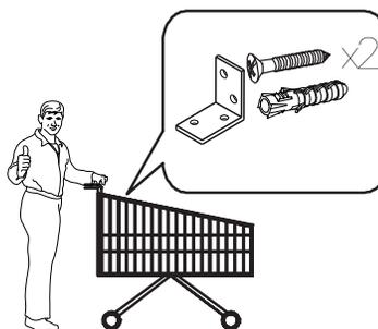
Для надежной устойчивости нужно зафиксировать шкаф к стене с помощью уголка. (Уголок и крепеж в комплект фурнитуры не входит )
