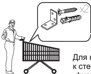
Для надежной устойчивости нужно зафиксировать пенал к стене с помощью уголка. (Крепеж в комплект фурнитуры не входит )
