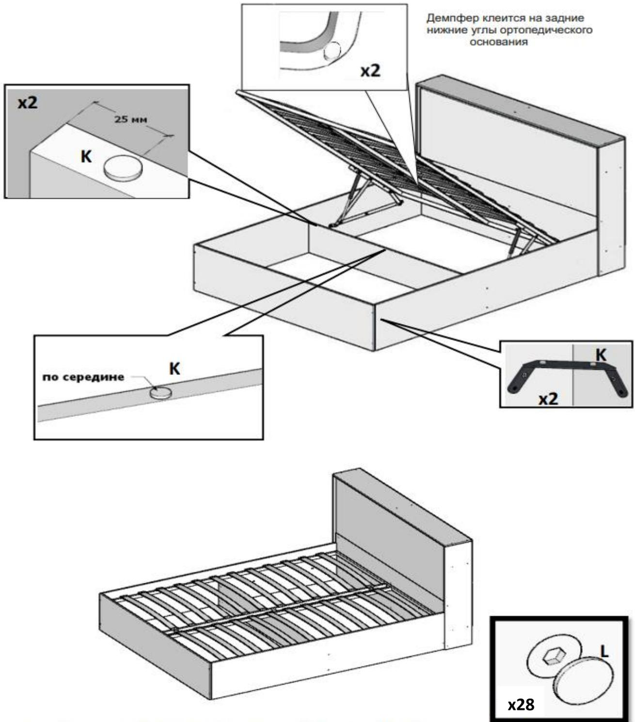
**Запрещается открывать и закрывать ортопедическое основание с установленными газлифтами без матраса**
