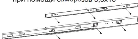
5. Сборочные единицы мебели с закрепленными на них частями шариковых направляющих совмещаются вместе и задвигаются до характерного щелчка.
