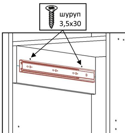
Подвести деталь 11 до задней стенки шкафа и полки шкафа, как на схеме, закрепить шурупами 3,5x30 к боковине или стойке шкафа.
