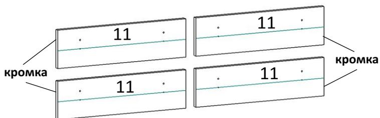
На детали 11 начертить линию по отверстиям 3 мм как показано на схеме.
