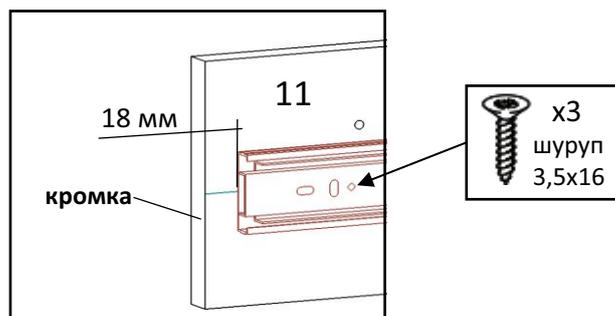
От стороны с кромкой отступить 18 мм до направляющей, закрутить шурупы в отверстия направляющей по линии на детали 11.
